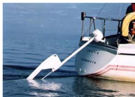
Устройство, которое я видел, при скорости лодки 5 узлов выдавало 72 Вт. Тормозящее действие винта процентов на 30 меньше, чем для буксируемого.
