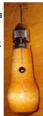
Специальное тонкое шило с тонкой промасленной ниткой – прекрасный инструмент для шитья вручную, гораздо более удобный чем игла. В отличие от иглы, с помощью шила шьют только с одной стороны материала, и им легко прокалывать много слоев ткани на шкаторинах и в местах усилений.
