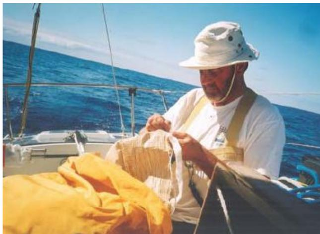
Работая с дакронем, вполне возможно даже удалить последствия прежнего ремонта и приступить к этому делу заново. Это бывает необходимо, особенно в наиболее нагруженных местах. Например, карманы для лат склонны рваться при тяжелой эксплуатации.
