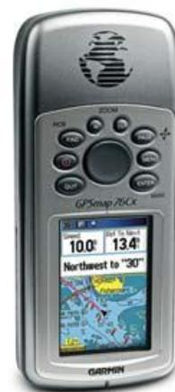
Можно использовать в качестве ручного навигатора и смартфон, например iPhone, но специализированные GPS и дешевле, и удобнее в работе на лодке.
