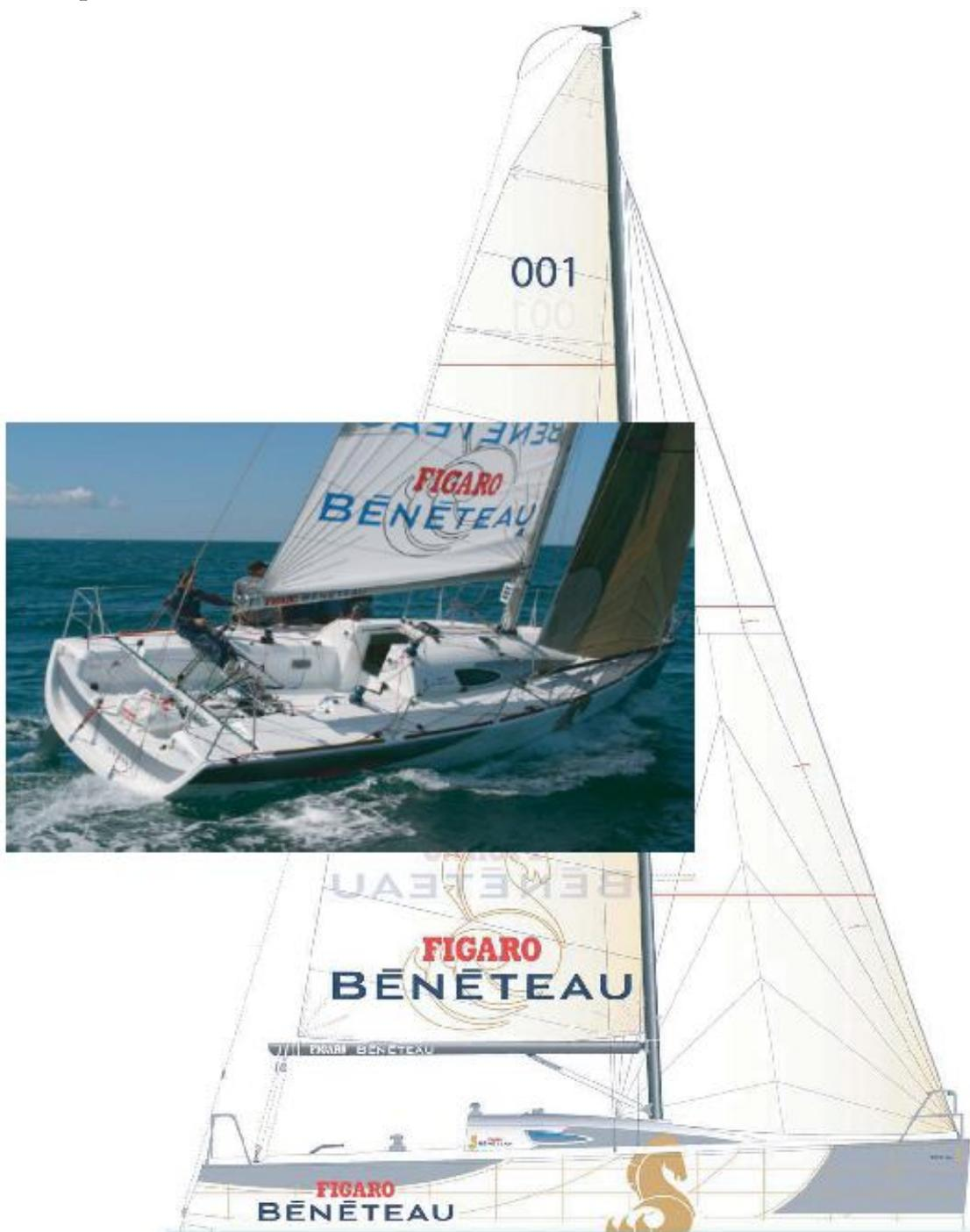
Для оптимального хода и управляемости яхты при попутном ветре корпус имеет широкие уплощенные обводы в корме; используются два руля. Яхтсмены - одиночники подчеркивали это требование, так как часто лодка идет под управлением
