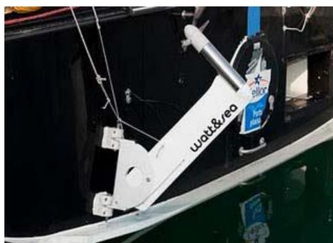
60. В спецификации модели Watt & Sea указано, что при скорости 8 узлов будет вырабатываться отличная мощность – 500 Вт.
