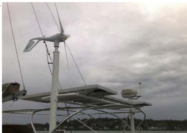
По-моему, панели надо просто крепить корпус лодки. Иногда делают крепления, позволяющие поворачивать панели, чтобы они лучше освещались солнцем. Это увеличивает выработку энергии, особенно в утренние и вечерние часы. Но моей концепции максимальной простоты такое решение не соответствует. Если панелей достаточно, выигрыш от их настройки будет невелик. Помните, что 80% результата получить легко, а последние 20% требуют больших усилий, которые не оправдываются.
