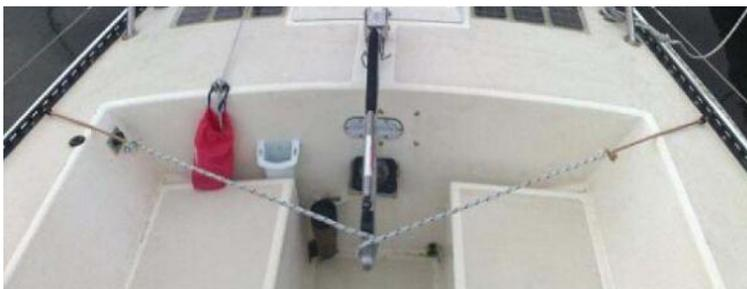
Готово! Вручную направьте лодку так, чтобы она уверенно шла нужным курсом. Паруса должны стоять под правильным углом атаки. Зафиксируйте румпель оборотом снасточки, в более сильный ветер для надежности можно сделать два и даже три оборота. Румпель должен оставаться в том же положении, которое вы задали при ручном управлении. Для этого может потребоваться небольшая настройка перемещением витков на румпеле или изменением натяжения концевых резинок.
