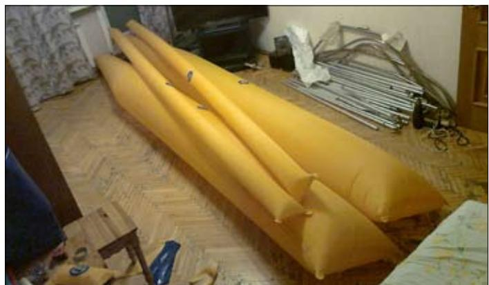
Готовые баллоны. Они односекционные, самой простой формы
