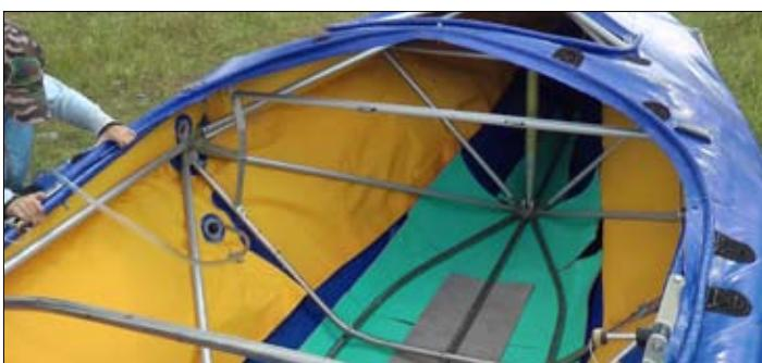
**Клапаны баллонов расположены рядом и в легкой доступности, позволяя в случае необходимости подкачать баллоны непосредственно из лодки. Между каркасом и оболочкой вдоль кильсона проложены туристические коврики-«пенки»**
