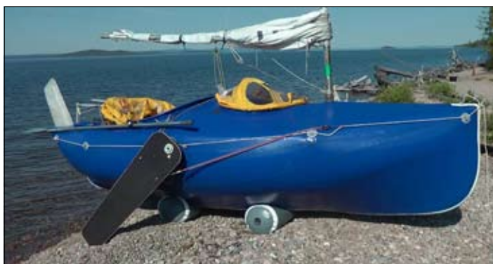
На берегу. От заваливания на бок предохраняют шверцы, зафиксированные в нужном положении
