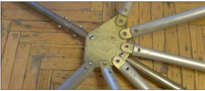
Типовой узел соединения элементов каркаса в виде «веера»
