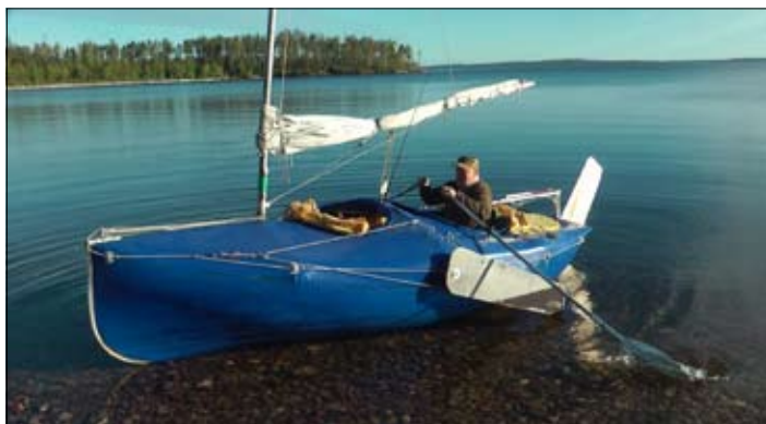
На берегу. От заваливания на бок предохраняют шверцы, зафиксированные в нужном положении
