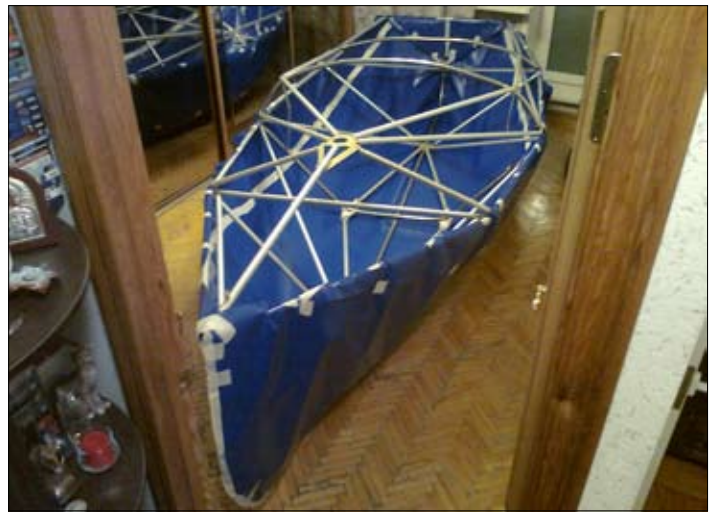
Процесс изготовления оболочки: «семь раз примерь, один раз отрежь». Все работы велись в условиях городской квартиры на собранном каркасе «по месту»
