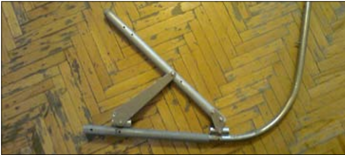
Натяжитель каркаса, «распирающий» оболочку корпуса
